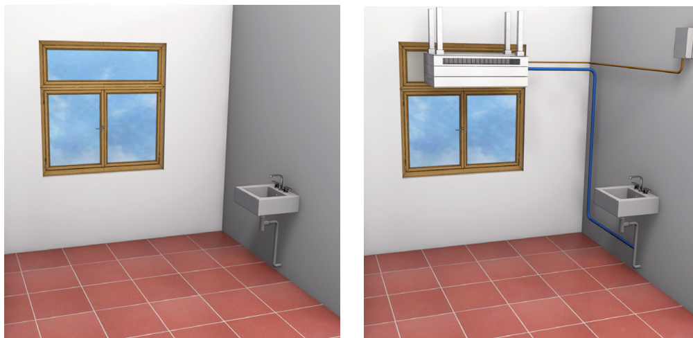
FIGURE 17 Etat initial (à gauche) – Intégration après dépose de la menuiserie en apparent (à droite)
