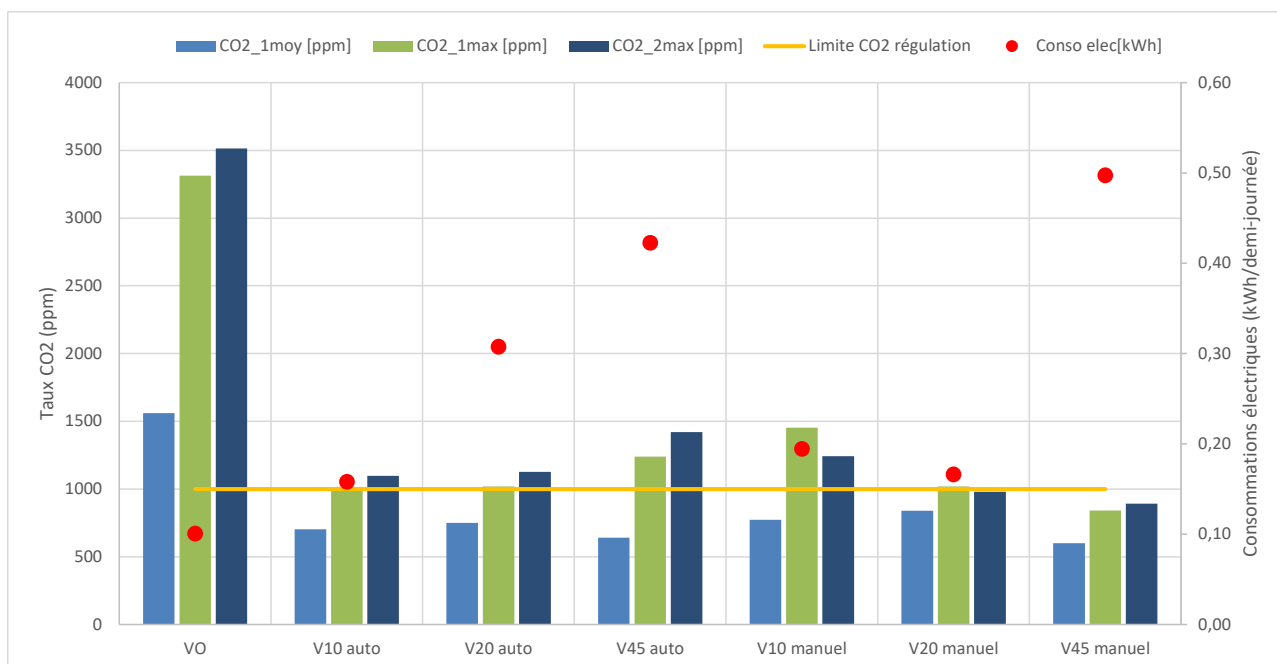
FIGURE 38 Résultats de l'instrumentation par demi-journée : Taux de CO 2 et consommations électrique en fonction du paramétrage
