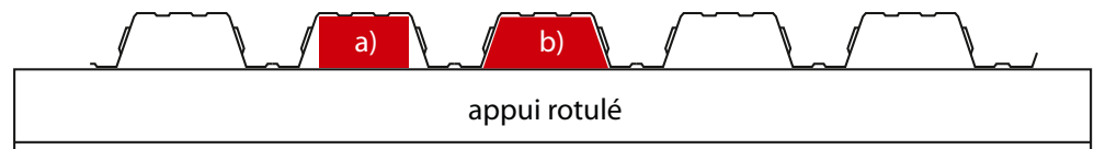
Figure B.4 – Calage sur appui d'une plaque soumise à l'essai « Eurocodes » de flexion simple
