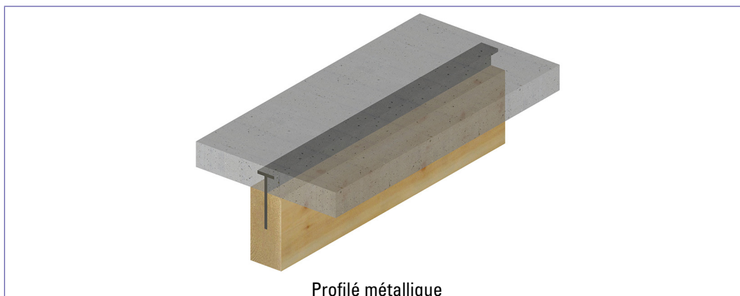
▲ Figure 5 : Liaisons continues par connecteurs filants (type d)
