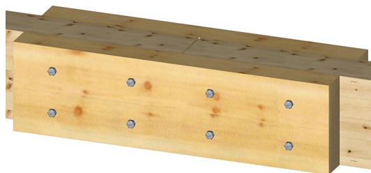
Assemblage de continuité par plaques en bois boulonnées
