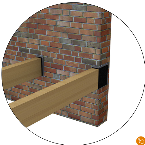
Solive scellée dans la maçonnerie (empochement)
