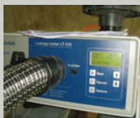
Raccordement du flexible de soufflage et de la sonde de pression à la machine de test
