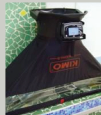
Ballomètre permettant de mesurer des débits pour de grandes bouches - AMOES
