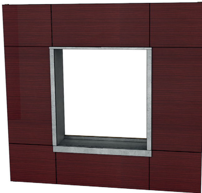
Figure 52.2 Encadrement de baie rapporté métallique calfeutré en applique extérieure - Vue de face
