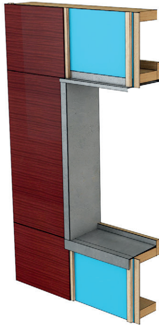
Figure 52.1 Encadrement de baie rapporté métallique calfeutré en applique extérieure - Vue 3D éclatée
